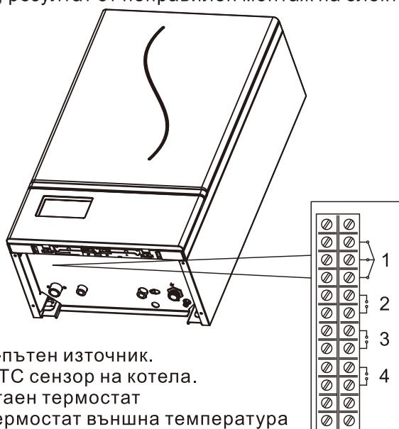
1. Терминал за 3-пътен източник.
